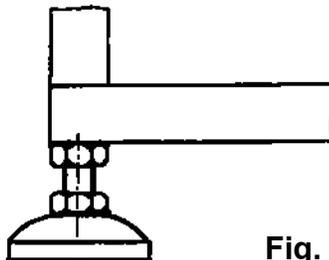
Fig. 5 SPARTAN Leveling Foot
