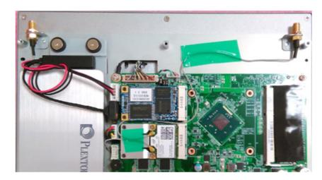
Figure 2.17 Antenna cables of Full-size mini PCle LAN module
