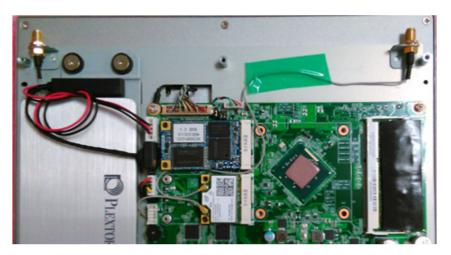
Figure 2.18 Antenna cables of Half-size mini PCIe LAN module
